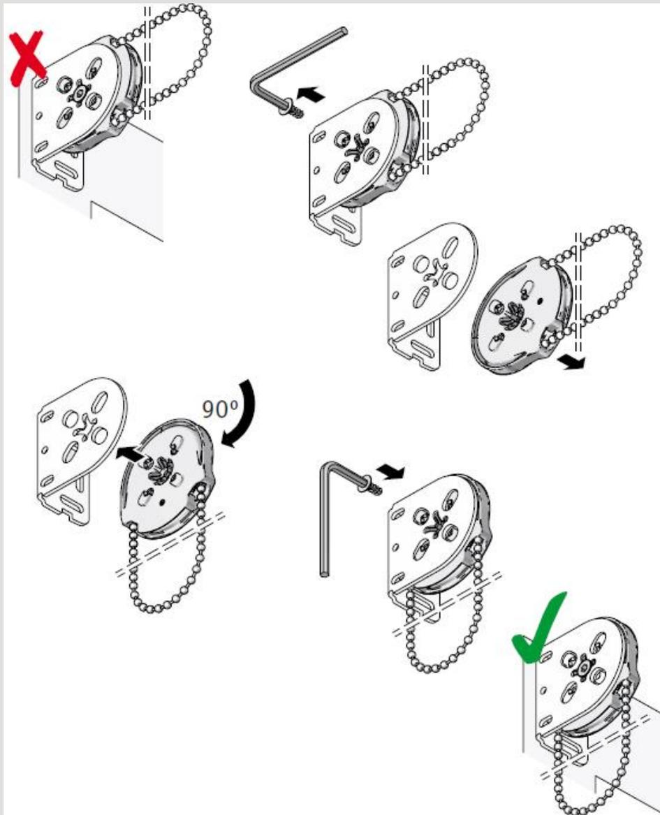
En **2 coups de clé**, nous changeons le sens de pose (plafond face) ou le côté de manoeuvre
