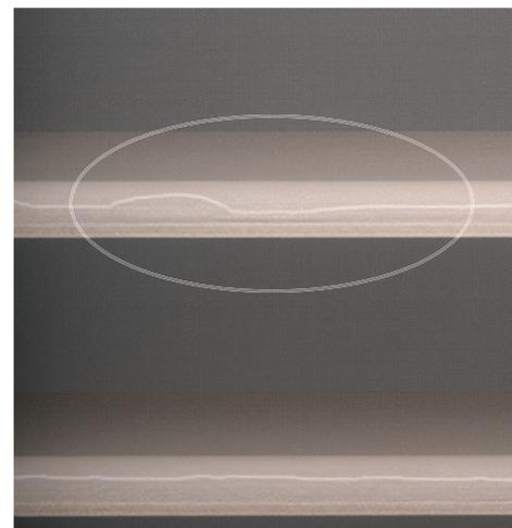
Des sillons peuvent apparaître sous la forme de petits plis horizontaux près de l'avant de la lamelle, le plus souvent visibles sur le voilage avant. Lorsque le store est ouvert en position basse, la chaleur du soleil peut contribuer à réduire ces plis.
